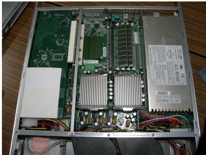
図 3.1: ホスト PC に搭載された状態の GP600M
